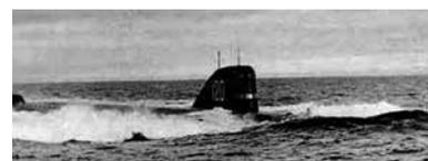
**Подлодка с двумя ядерными реакторами ВТ-1 с жидким металлом в качестве теплоносителя в первую очередь была научным проектом, и уже потом — действующей в боевом составе флота ударной субмарины. Но несмотря на рекорды и успехи, ее век был недолог.**
